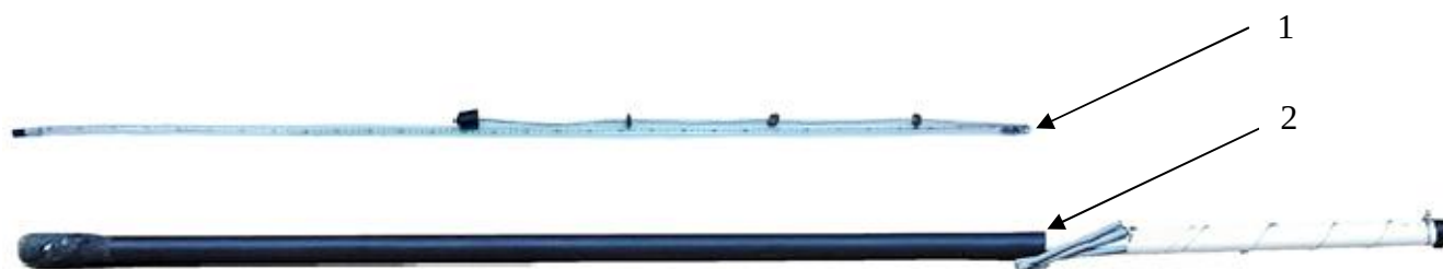
Рисунок 1 – Общий вид мерзлотомеров АМ-21 1 – защитная трубка, 2 – трубка ПВХ с измерительной шкалой
